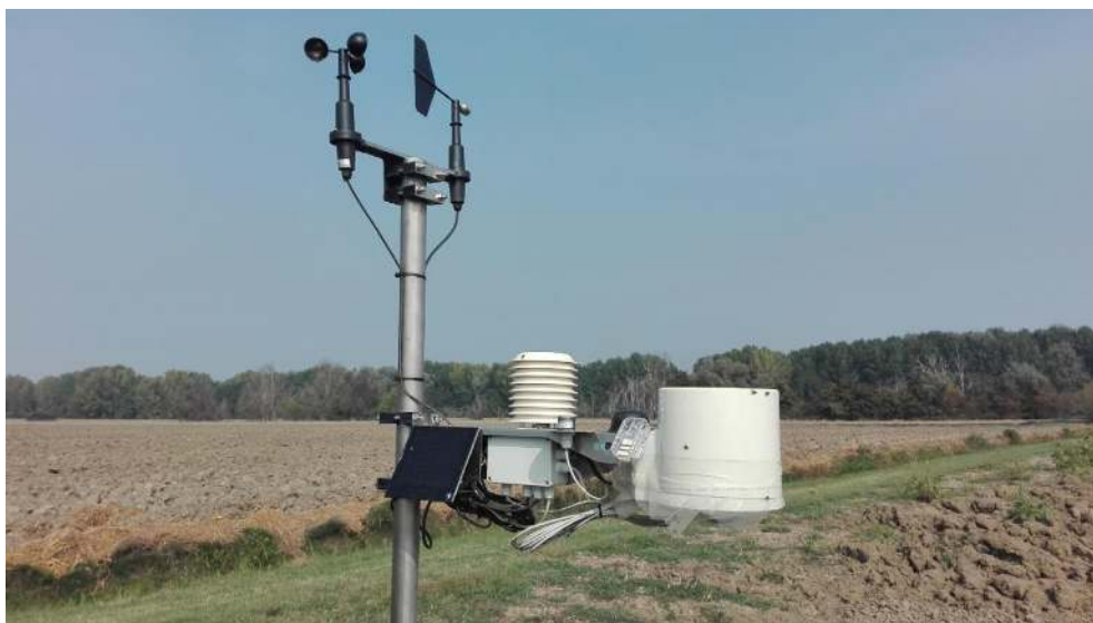
Figura 30 - Stazione di misura dei principali parametri meteorologici
