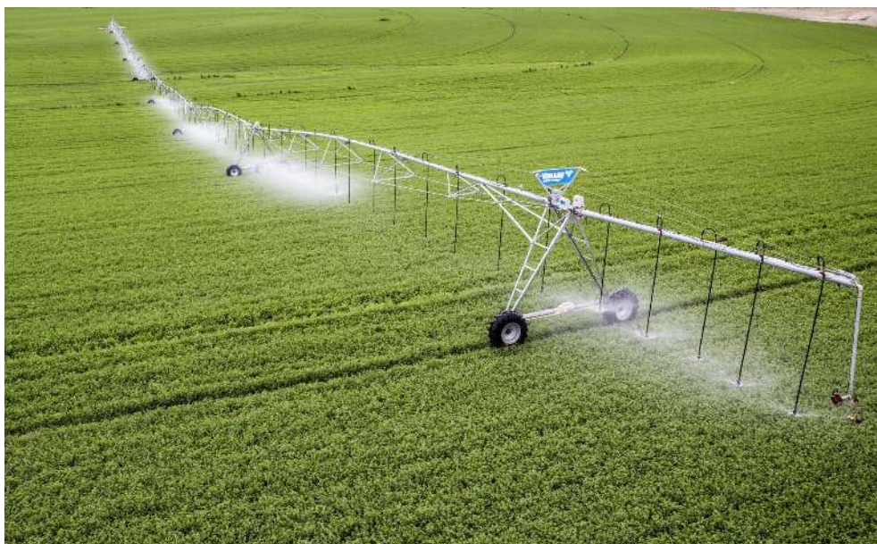
Figura 34 - Pivot con tecnologia di gestione delle zone irrigue a rateo variabile
