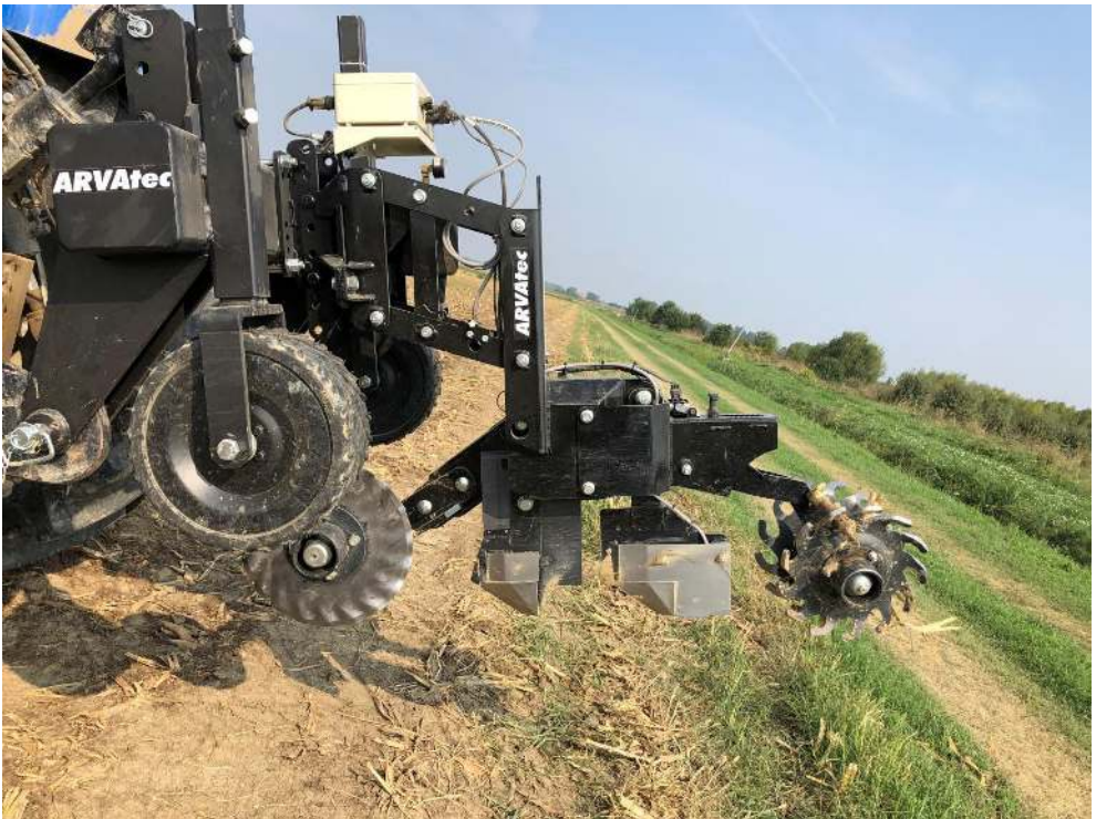
Figura 29 - Sensore geoelettrico con contatto del suolo (Fonte Arvatec)
