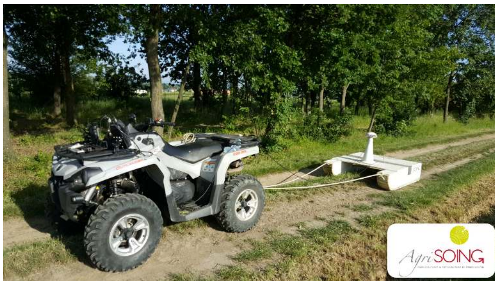
Figura 27 - Georesistivimetro trainato (Fonte AgriSoing)
