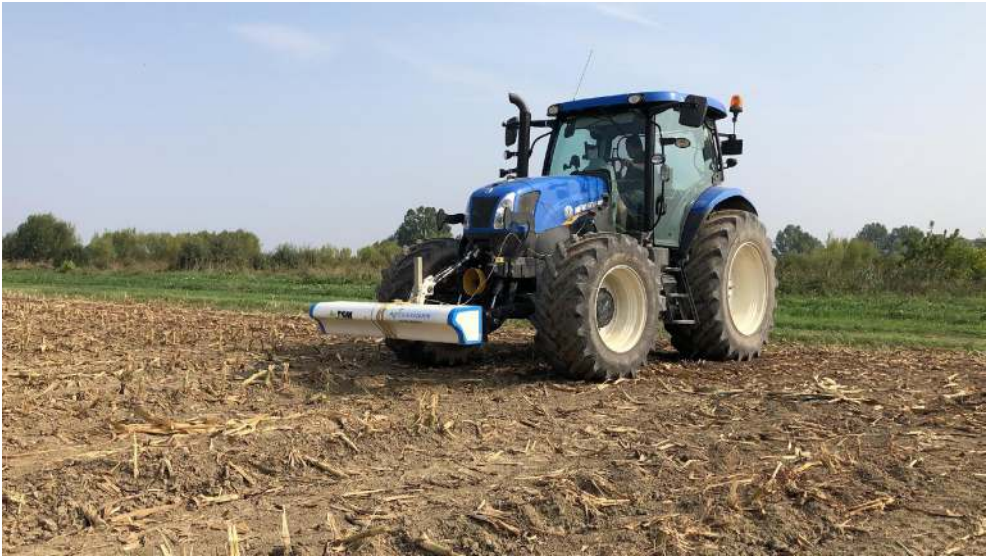
Figura 28 - Sensore geoelettrico installato su trattore senza contatto con il suolo (Fonte Agrinnovazione)
