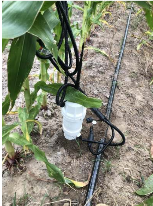
Figura 31 - Sonda multilivello per il monitoraggio del contenuto idrico del suolo
